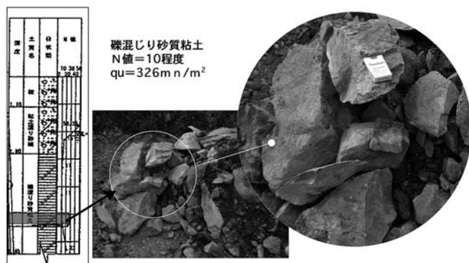
写真-3 発進立坑（坑口部）の掘削土
