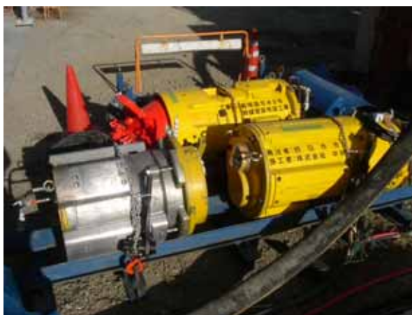
写真 - 5 分割された先導体の状況
